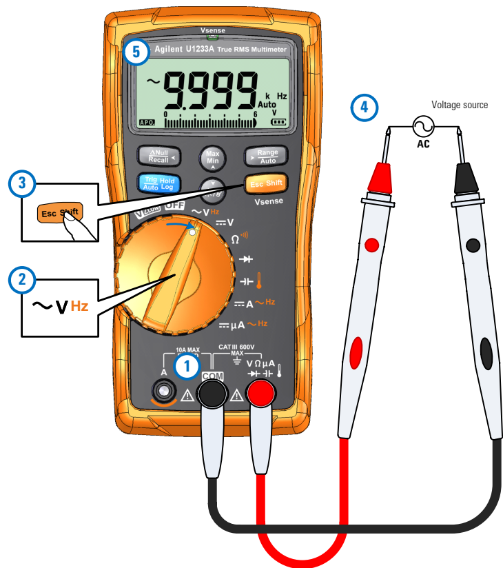
Figura 2-28 Medición de frecuencia
