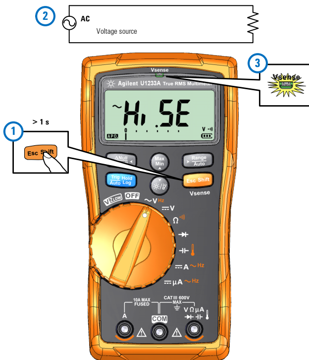
Figura 3-1 Detección de presencia de tensión
